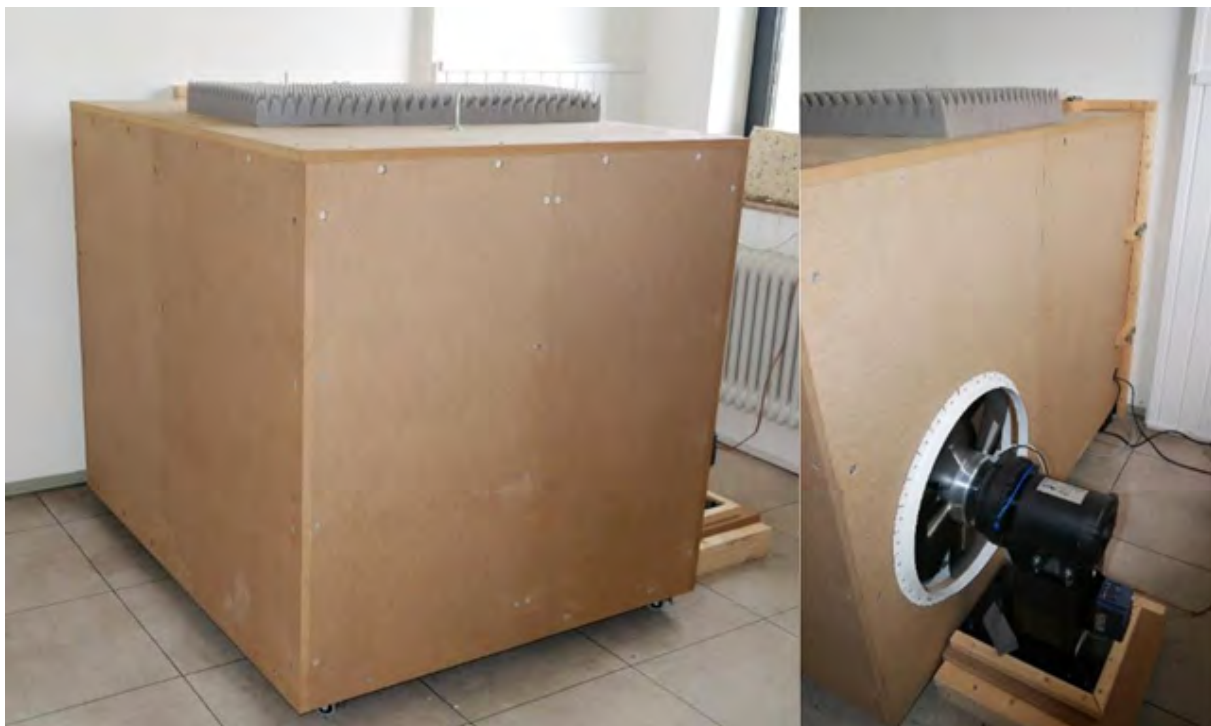
Abbildung 17: Gehäuse des Infraschallgenerators an der Wand zum Hörraum und mit dem seitlich positionierten TRW-17, der die Luft im Gehäuse zu einer oszillierenden Bewegung anregt
